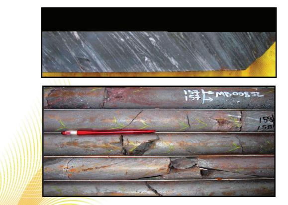
FIGURE 7 - SUPERGENE AND ITABIRITE DRILL CORE
